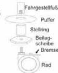
Nehmen Sie das Fahrgestell vorsichtig aus der Verpackung und von der Palette. Um den Transport zu erleichtern, wird das Fahrgestell ohne montierte Rollen ausgeliefert. Diese können anhand der Zeichnung auf der rechten Seite leicht montiert werden. Befestigen Sie die Bremsen an den Rädern und schrauben Sie nun alles zusammen.
