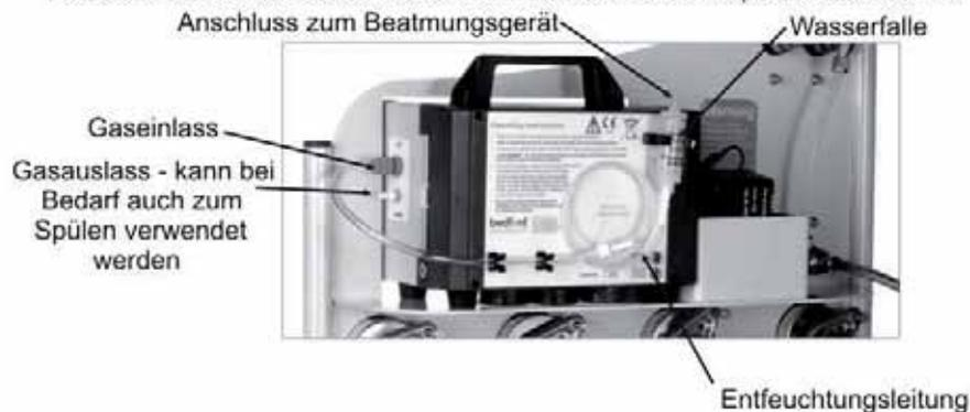
6. Wenn keine Absaugvorrichtung vorhanden ist, werden die Abgase in die Raumluft abgegeben, bei Verwendung eines Abluftschlauches darf jedoch kein Widerstand entstehen. Anderenfalls ist an den Abluftschlauch ein geringer Unterdruck anzuschließen. Maximal sollte am Gerät ein Druck von 80cm Wassersäule anliegen.
